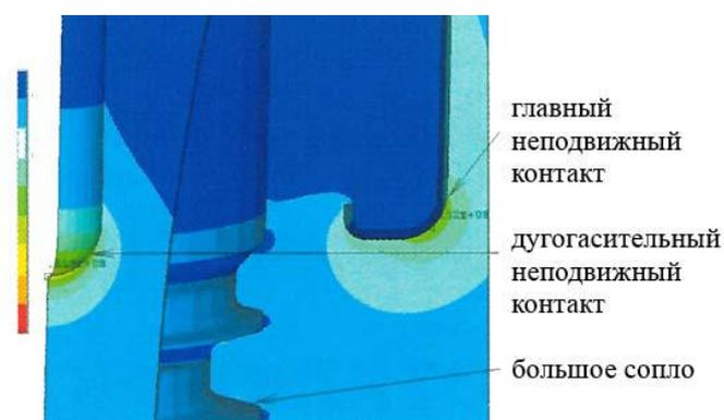
Рис. 2. Максимальная напряженность на неподвижном дугогасительном контакте.
