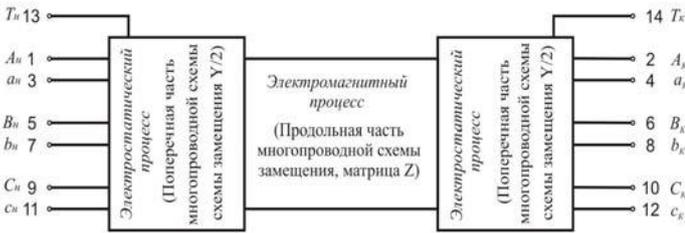
Рис. 2 – Модель разомкнутой линии при размыкании фазы на два провода.
