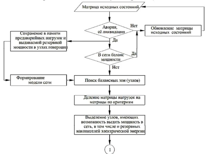
Рис. 18. Блок-схема мониторинга аварийных состояний электрической сети
