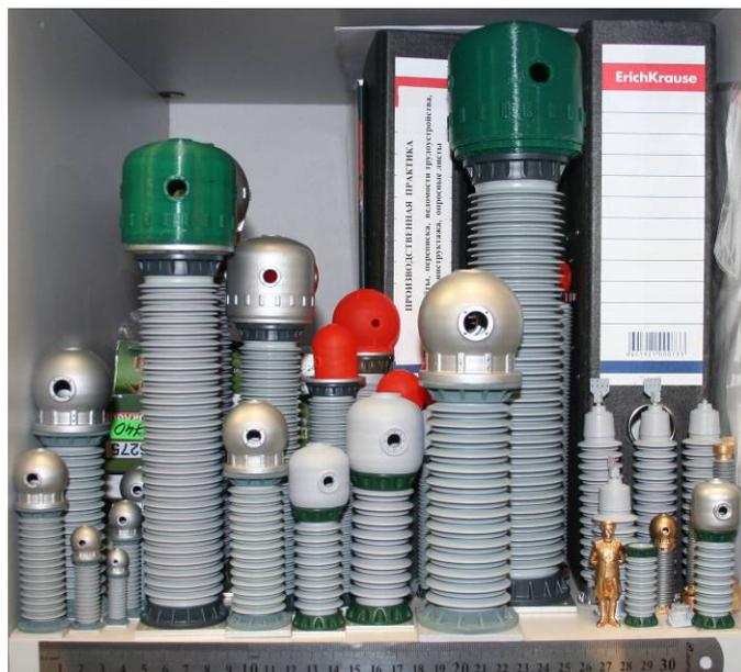
Рис. 4. Прогрессия трансформаторов тока серии ТРГ в масштабах 1/10÷1/50 напечатанная на 3D принтере StarLight по технологии SLA. Основная часть ТРГ-35, ТРГ-110 и ТРГ-220 в масштабах 1/16, 1/13 и 1/10
