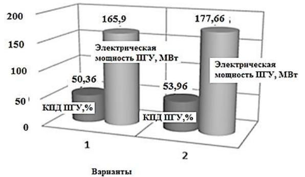
Рис. 3. Изменение КПД и электрической мощности ПГУ без промперегрева и при внедрении промперегрева
