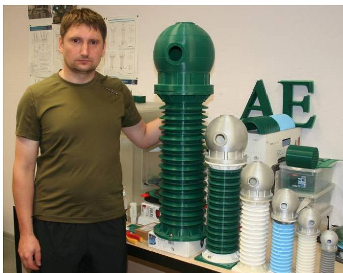
Рис. 5. Прогрессия трансформаторов тока серии ТРГ-110 в масштабах 1/2÷1/8 напечатанная на 3D принтере CubeX по технологии FDM
