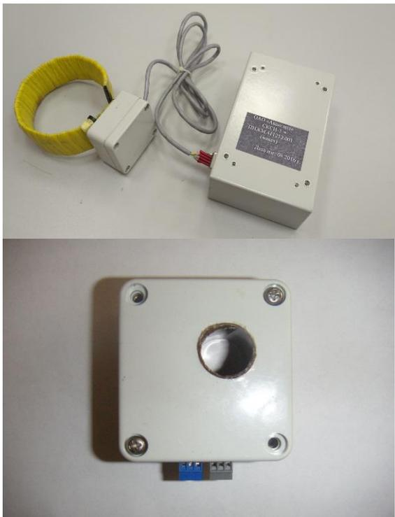
Рис. 4. Опытные образцы датчиков тока для системы пофидерного контроля состояния изоляции
