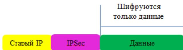
Рис. 2. Работа IPSec в транспортном режиме
