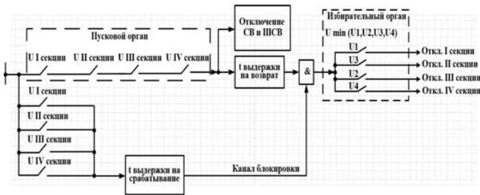
Рис. 2. Структурная схема устройства АРЗБКЗ Краснодарской ТЭЦ.
