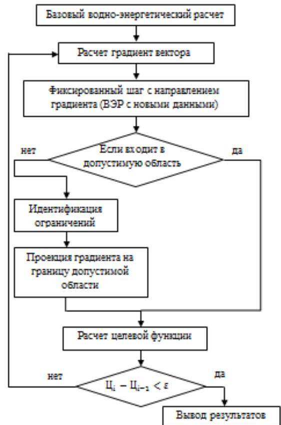
Рис.2 Структура алгоритма оптимизации (градиентный метод)
