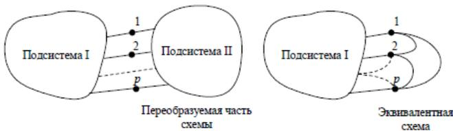
Рис. 1. Условное изображение ЭЭС с эквивалентируемой частью
