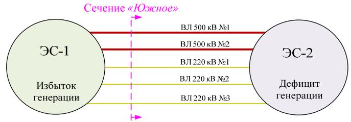
Рис. 5. Схема условного контролируемое сечение «Южное»
