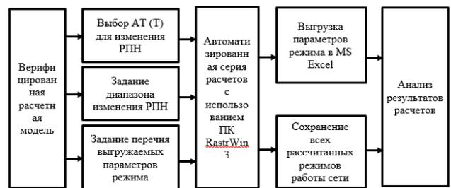
Рис. 1. Блок-схема предложенного алгоритма
