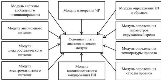
Рис. 1. Структурная схема модульного устройства
