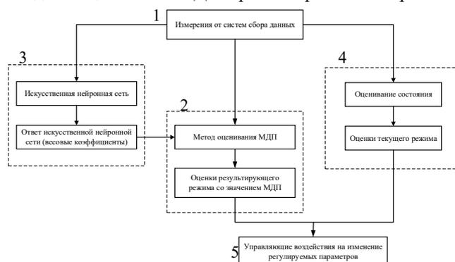
Рис.1 Блок-схема методики оценивания МДП
