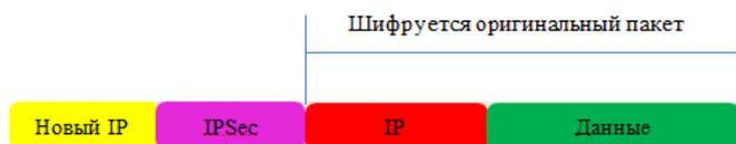
Рис. 1. Работа IPSec в туннельном режиме
