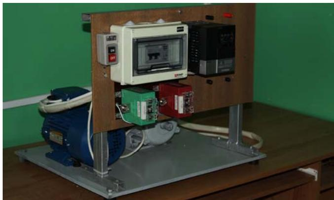
Рис. 3. Стенд для исследования режимов работы магнитоэлектрической машин
