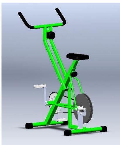
Рис.1 Размещение аксиального генератора на велотренажере
