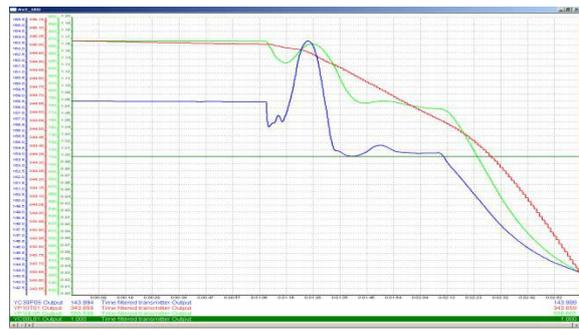
Рис. 3. Изменение во времени параметров теплоносителя в компенсаторе давления и уровень теплоносителя в реакторе.
