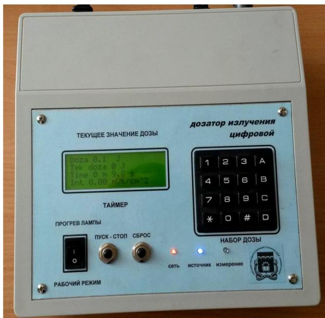
Рис.3. Дозатор ультрафиолетового излучения.
