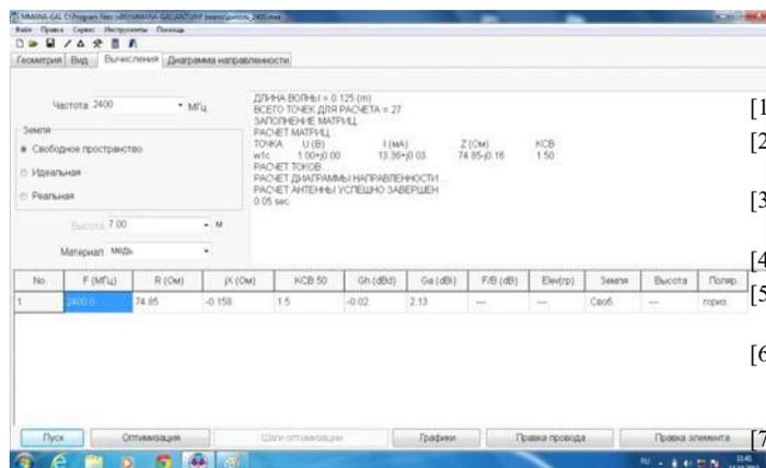
Рис. 2. Расчёт параметров антенны типа «Диполь» в программе Mmana
