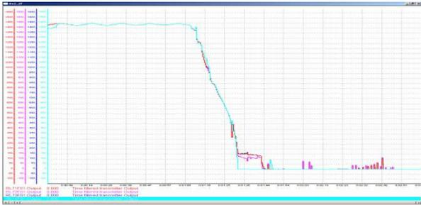
Рис. 8. Изменение во времени расхода питательной воды в парогенераторы.
