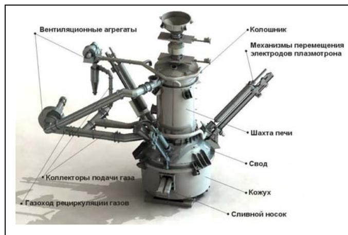
Рис. 1. Модель плазменной шахтной печи для технологии «EPOS-process» и вид крепления плазматрона [5].
