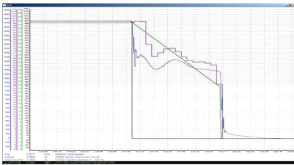
Рис.2. Изменение во времени нейтронной, тепловой и электрической мощностей, а также положения стержней СУЗ.
