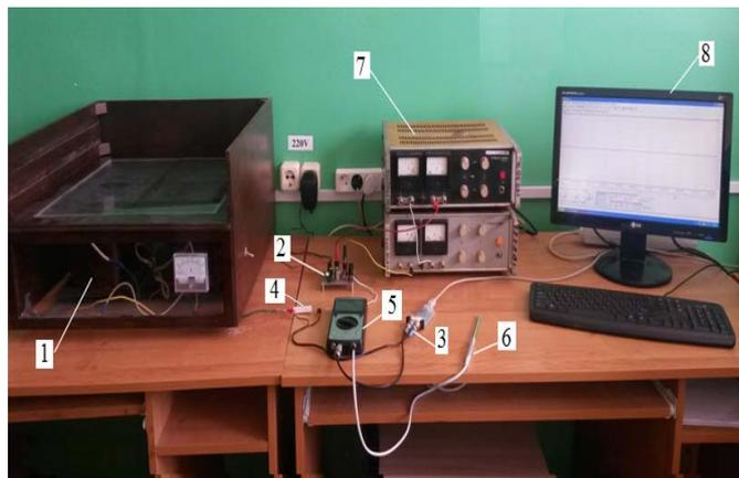
Рис.1. Внешний вид испытательного стенда: 1–опытный образец ЭЖ; 2–электронный ключ; 3 –USB осциллограф; 4 – датчик тока; 5– цифровой милливольтметр; 6 – датчик Холла; 7 – источник постоянного напряжения; 8 – персональный компьютер.
