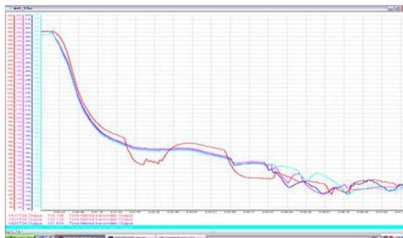
Рис. 5. Изменение во времени средние температуры теплоносителя по циркуляционным петлям.
