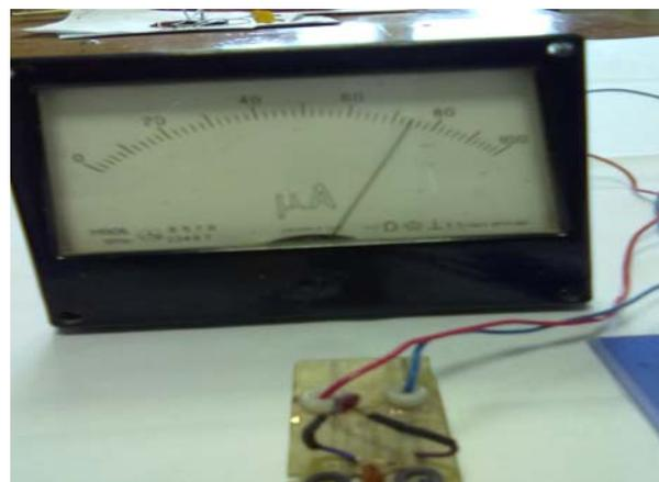
Рис. 4. Замер СВЧ-излучения микроволновой печи
