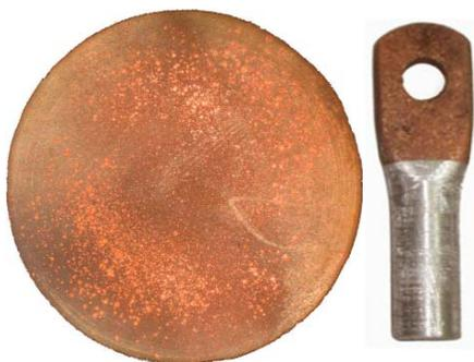
Рис. 2. Фотографии полученных медных покрытий на алюминиевых подложках и электротехнических изделиях
